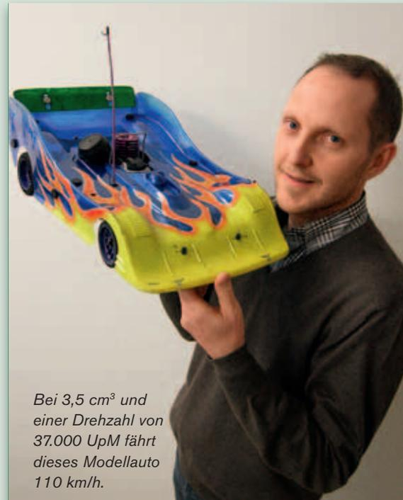
Bei 3,5 cm<sup>3</sup> und einer Drehzahl von 37.000 UpM fährt dieses Modellauto 110 km/h.
